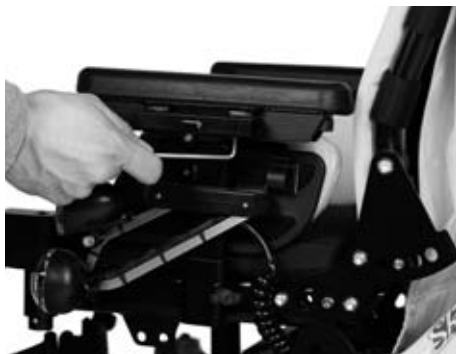
III. 19 Adaptation des accoudoirs à la longueur de l'avant-bras
