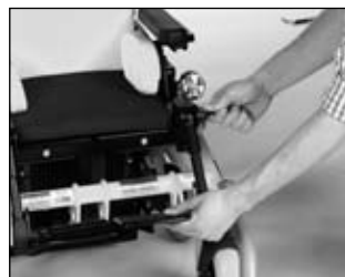
III. 24 Réglage de la longueur des jambes
