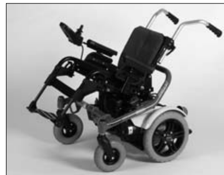
III. 40 Bascule électrique de l'assise
