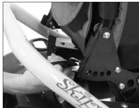
Ill. 15 Sangle de déverrouillage du dossier
