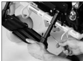
III. 24 Réglage de la longueur des jambes
