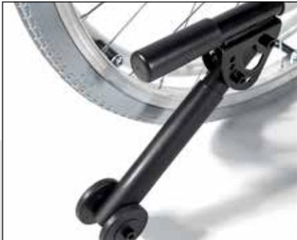
Système anti-basculé avec anti-chûte intégré dans le châssis.
