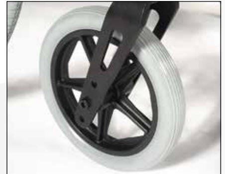
Les roues avant existent en 6" (pleines souples et pleines), 7" (pleines) et 8" (pneumatique, pleines souples et pleines).
