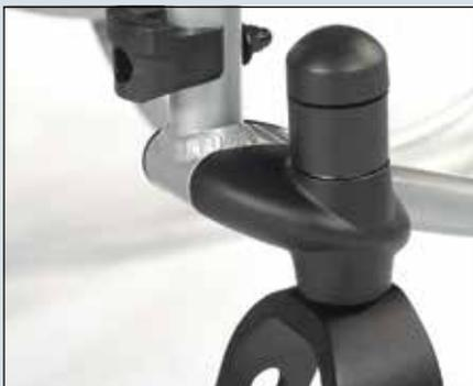
Système de tête de fourche réglable pour ajuster la hauteur d'assise et l'inclinaison du siège (0°, 3° et 6°).
