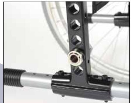
Réglage de la plaque d'axe pour ajuster la hauteur du siège et le centre de gravité.
